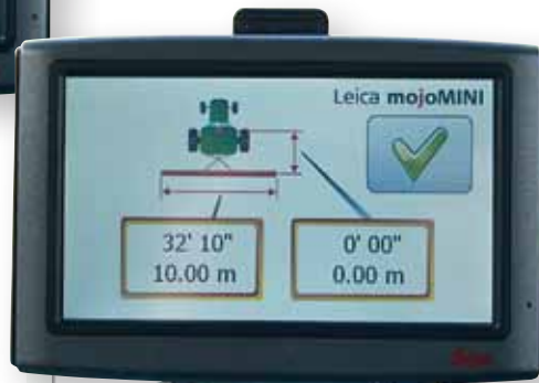
Vor jedem neuen Einsatz werden die Arbeitsbreite und der Antennenabstand abgefragt. Metrische und Zoll-Einheiten sind nicht wählbar und werden immer angezeigt.
