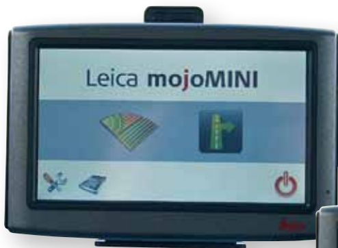
Auf dem Startbildschirm wählt man die Parallelführung (links) oder das Straßennavi. Unten links lässt sich ein Taschenrechner oder das Setup einblenden.
