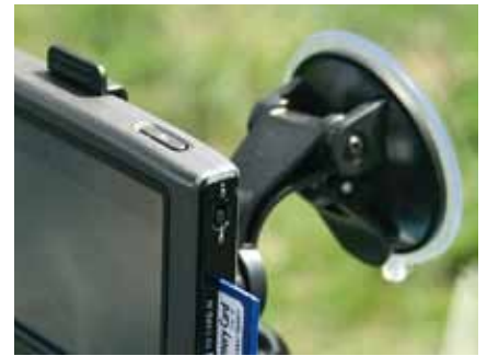
Die Saughalterung war im Test stabil. Die SD-Karte speichert Feldumrisse und bearbeitete Zonen als kml-Datei. Diese lassen sich später am PC in GoogleEarth darstellen.
