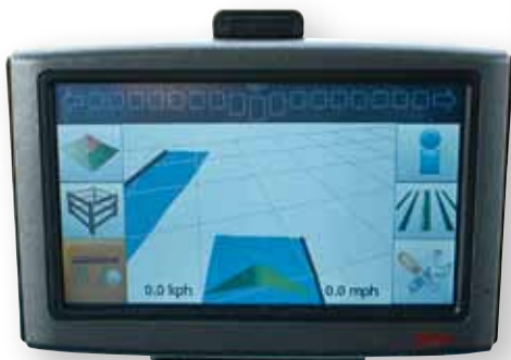
Das mojoMini kann die bearbeitete Fläche aufzeichnen. Zusätzlich lässt sich die linke oder rechte Außenkante zur Flächenberechnung auswählen. Fotos: Böhrnsen, Holtmann
