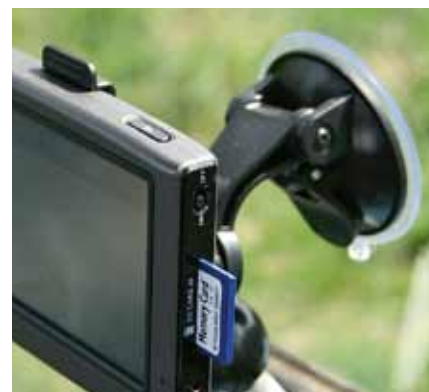
Крепление прибора с помощью присоски во время тестирования было стабильным. SD-карта сохраняет очертания поля и обрабатываемые участки в формате KML. Затем их можно найти в Интернете в программе GoogleEarth (Google Планета Земля).
