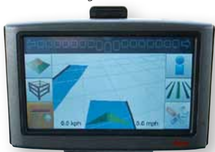
Прибор mojoMini способен записывать и отображать обрабатываемую область. Кроме того, левый или правый край монитора можно выбрать для подсчета обработанной площади. Фотографии: Бернзен, Хольтманн.
