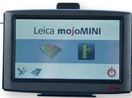
При включении прибора на стартовом экране можно выбрать функцию параллельного вождения (кнопка слева) или дорожной навигации (кнопка справа). Слева внизу можно выбрать функцию „калькулятор“ или „базовые настройки“.
