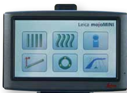
Кнопки режимов вождения по полю: „А-Б“, „заданный контур“, „А+“ направление (в градусах), „круговое движение“. Кнопка справа внизу активирует функцию записи и отображения обрабатываемой области, которая также подсчитывает обрабатываемую площадь.
