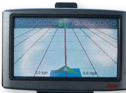
Комбинация из световых курсоуказателей сверху экрана и перспективных линий делают небольшой экран не таким уж серьезным недостатком, а при управлении трактором они очень помогают.
