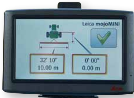
При каждом новом использовании прибора необходимо вводить рабочую ширину захвата агрегата и расстояние от него к антенне. Показания в метрах и дюймах переустановить (или изменить) нельзя, они выводятся на экран постоянно.
